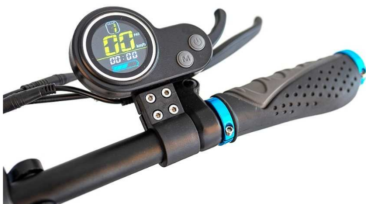
Reloj indicador, velocidad, estado de batería
